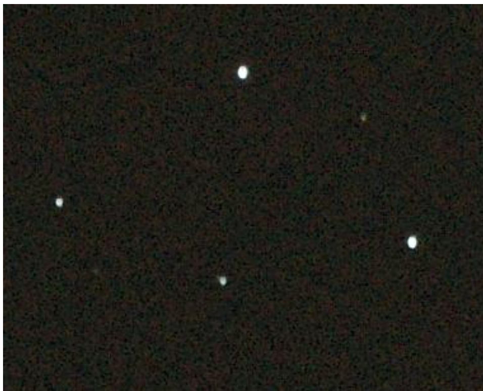
Abbildung 9: Sternabbildung auf dem CCD und Dunkelrauschen (1:1 Ausschnitt)
